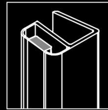
Junta magnética plana 90° para fijo lateral 6/8 mm
