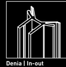
Junta estanquedad vidrio pivote giro 6 mm
